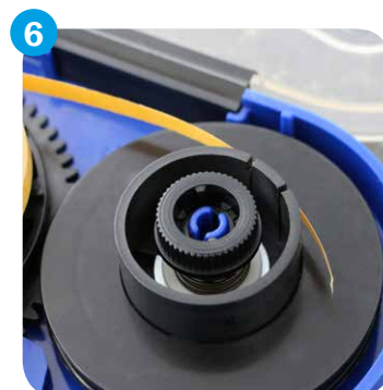
6 ...und dann nach hinten führen ... and over left wheel to the back
