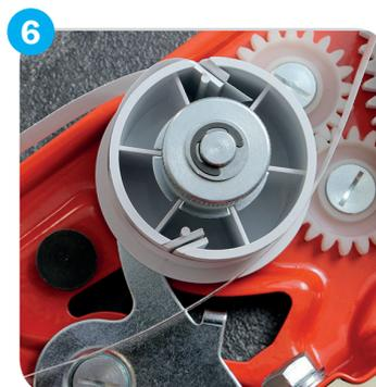
... das Trägerpapier von oben in die hintere Rolle einfädeln
