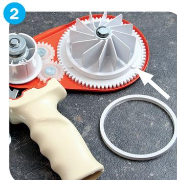
Distanzringe für unterschiedliche Klebebandbreiten
